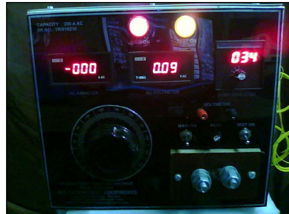
TEMP. RISE CUM VOLTAGE DROP TEST APPARATUS
